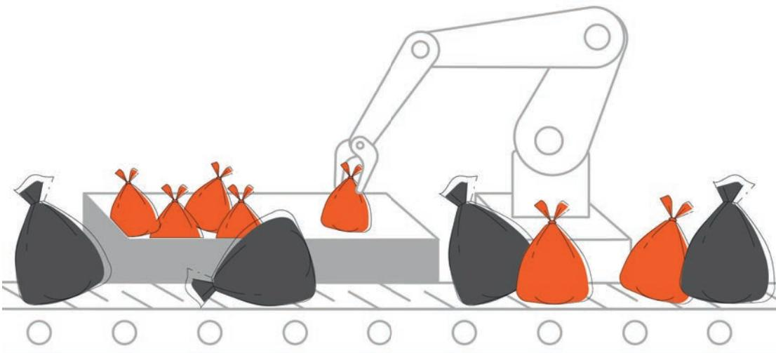
Les sacs orange et noirs sont orientés vers KEREA, l'Unité de Valorisation Energétique et Organique basée à Viviez. Ils sont alors séparés par des bras robotisés contrôlés par l'intelligence artificielle. Ces robots identifient les sacs orange et les mettent de côté.
