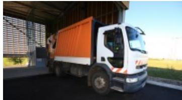
2. Le camion de collecte arrive sur la zone de déchargement et vide son contenu par l'intermédiaire d'une trémie dans le compacteur à poste fixe,
