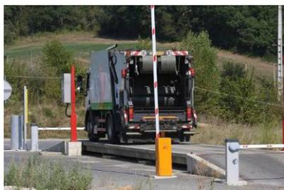
Avant de partir, le camion est pesé une seconde fois afin de déterminer la quantité de déchets déposés.
